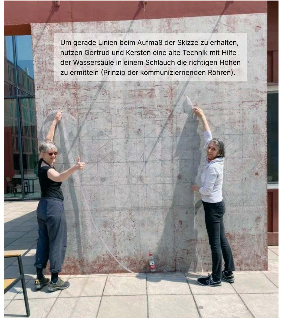
Um gerade Linien beim Aufmaß der Skizze zu erhalten, nutzen Gertrud und Kersten eine alte Technik mit Hilfe der Wassersäule in einem Schlauch die richtigen Höhen zu ermitteln (Prinzip der kommunizierenden Röhren).
